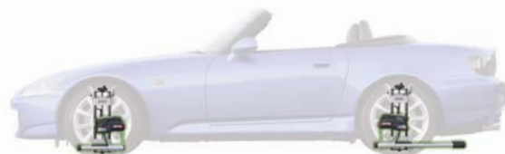
... реверсивное расположение для "обхода" низкого переднего спойлера.
