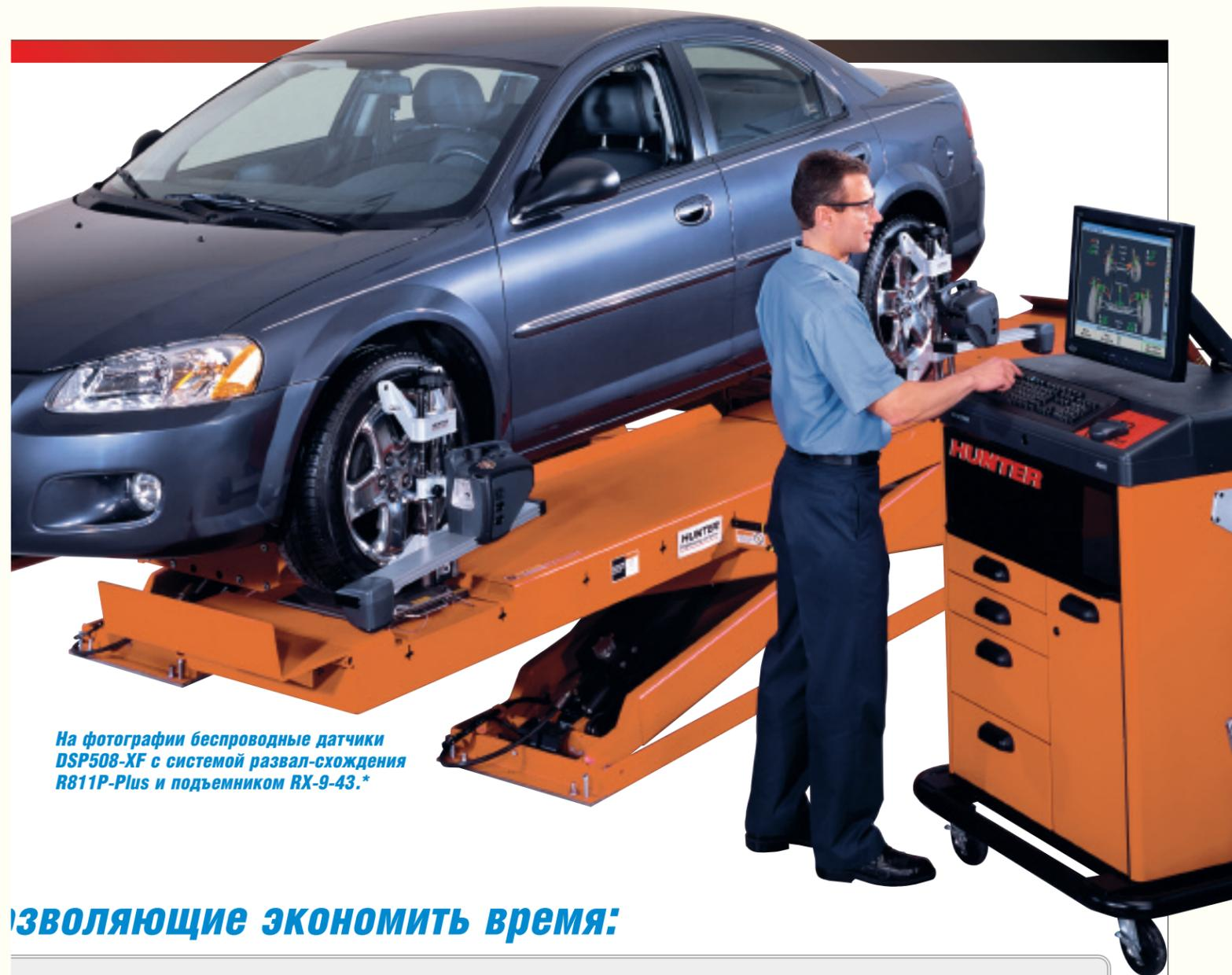
На фотографии беспроводные датчики DSP508-XF с системой развал-схождения R811P-Plus и подъемником RX-9-43.\*
