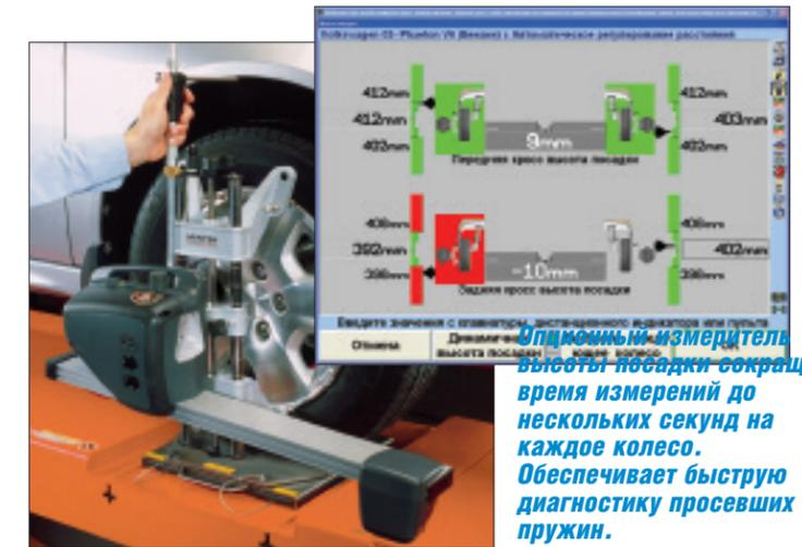
Опционный измеритель высоты посадки сокращает время измерений до нескольких секунд на каждое колесо. Обеспечивает быструю диагностику просевших пружин.
