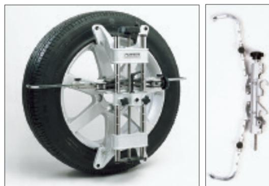
Комплект 20-1789-1 состоит из четырех шинных захватов. (На рисунке установлен на стандартном самоцентрирующемся адаптере)
