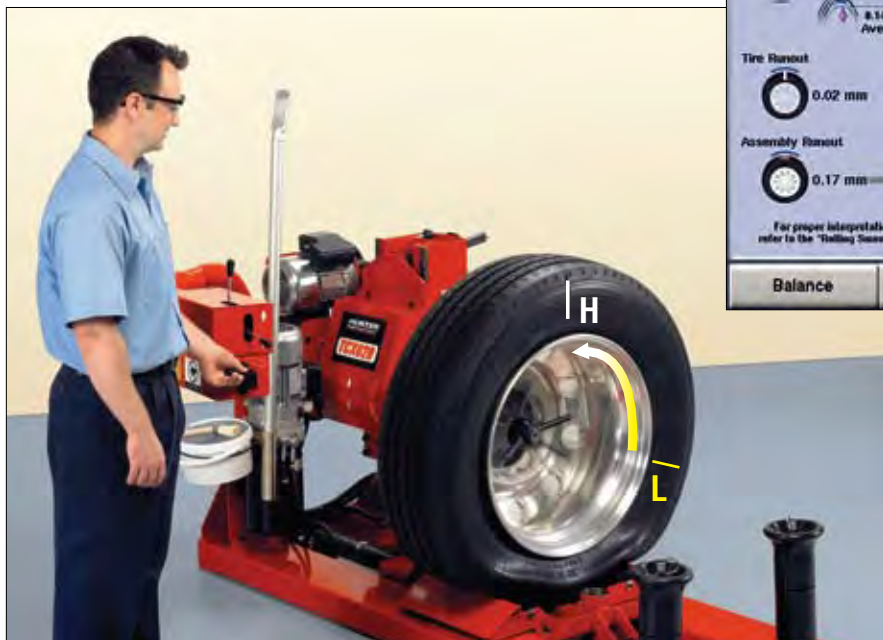
Функция match-mounting на GSP9600HD даёт точные инструкции оператору, как повернуть шину на ободу, чтобы устранить вибрацию.
