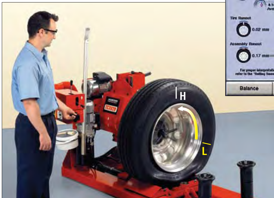
Функция match-mounting на GSP9600HD даёт точные инструкции оператору, как повернуть шину на обод, чтобы устранить вибрацию.
