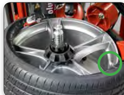
Монтаж верхнего борта
