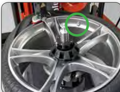
Демонтаж верхнего борта
