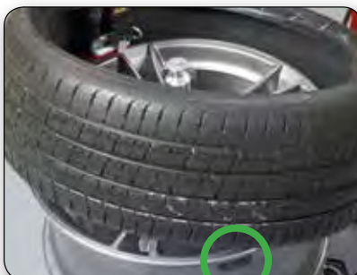
Монтаж нижнего борта
