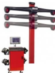
Hunter WA 310/20LE-421ML3 Стенд развал-схождения, кабинет мобильный экономичный; ОС Windows; WinAlign Elite, WebSpecs, Photo/Video опция; Монитор LCD 21.5" с креплением; Принтер цветной; Мульти-D, 4 камеры, механический лифт, трехмерные (TD) мишени, адаптеры быстрого зажима; Круги поворотные.
