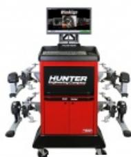
Hunter WA360/22LE-708 Стенд развал-схождения Кабинет мобильный стандартный; ОС Windows; WinAlign Elite, WebSpecs, Photo/Video опция; Монитор LCD 21.5" с креплением; Принтер цветной; 4 инфракрасных беспроводных датчика с 8 CCD сенсорами схождения и 8 сенсорами развала/продольного наклона, компенсация биений прокатыванием, адаптеры колесные 10-24,5"; Круги поворотные.
