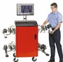
Hunter WA310/20LE-706 Кабинет мобильный экономичный; ОС Windows; WinAlign Elite, WebSpecs, Photo/Video опция; Монитор LCD 21.5" с креплением; Принтер цветной; 4 инфракрасных беспроводных датчика с 6 CCD сенсорами схождения и 8 сенсорами развала/продольного наклона, компенсация биений прокатыванием, адаптеры колесные 10-24,5"; Круги поворотные.
